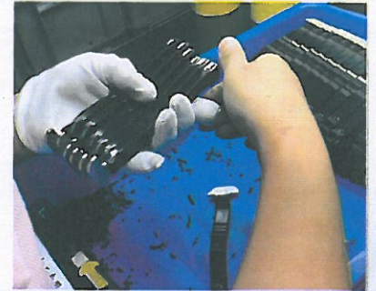
3. 按《检查要领书》要求进行外观检查需逐个对产品进行检查
