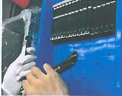
2. 参考《检查要领书》对产品溢料部位进行修平, 溢料翘起不可
