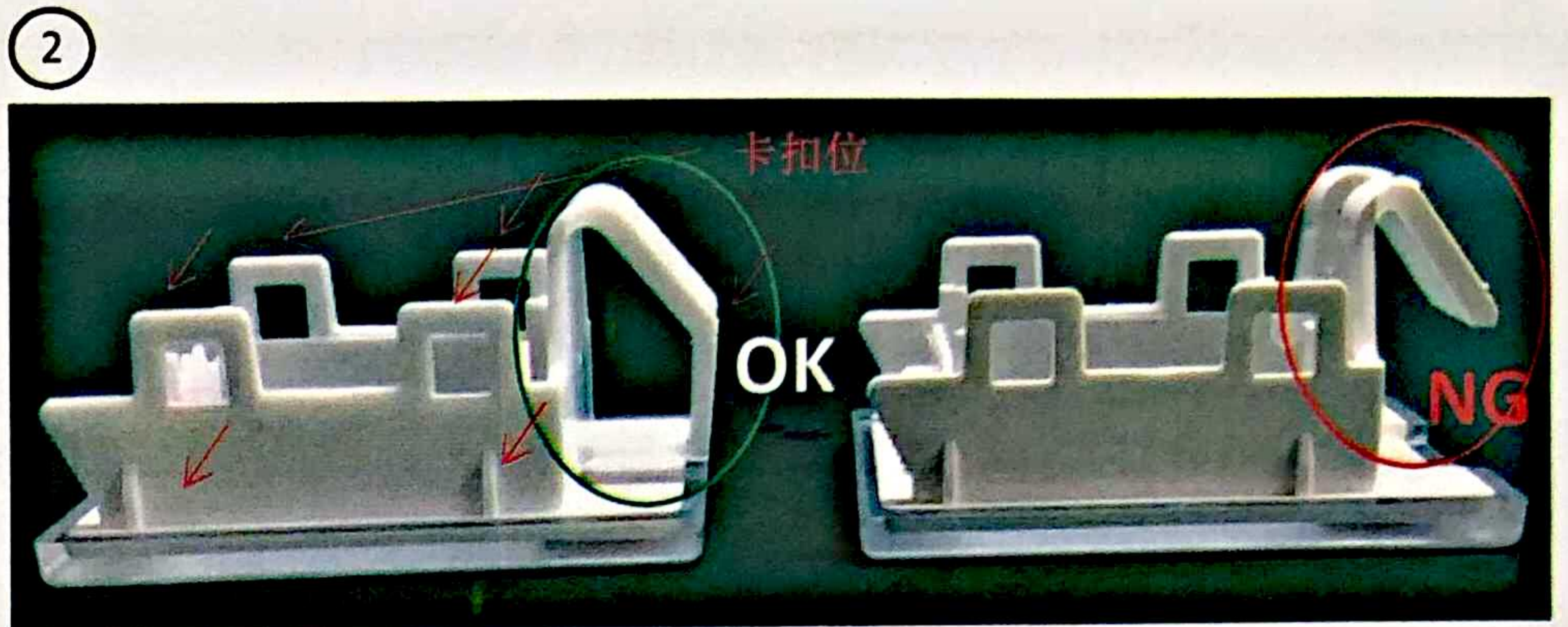
② 卡口位完好, 无伤缺、变形、拖伤等不良, 用手扳动韧性良好, 无断裂。
